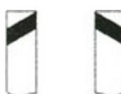
**2.5** - обозначает боковые поверхности ограждений дорог на закруглениях малого радиуса, кругих спусках, других опасных участках;
