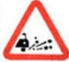
**1.19** "Опасная обочина". Участок дороги, на котором съезд на обочину опасен.
