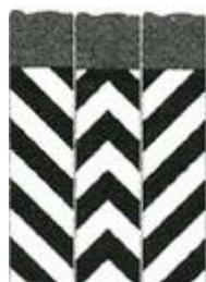
**2.2** - обозначает нижний край пролетного строения тоннелей, мостов и путепроводов;
