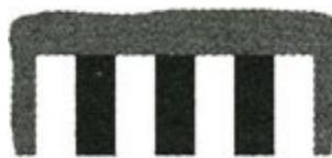
**2.3** - обозначает круглые тумбы, установленные на разделительных полосах или островках безопасности;
